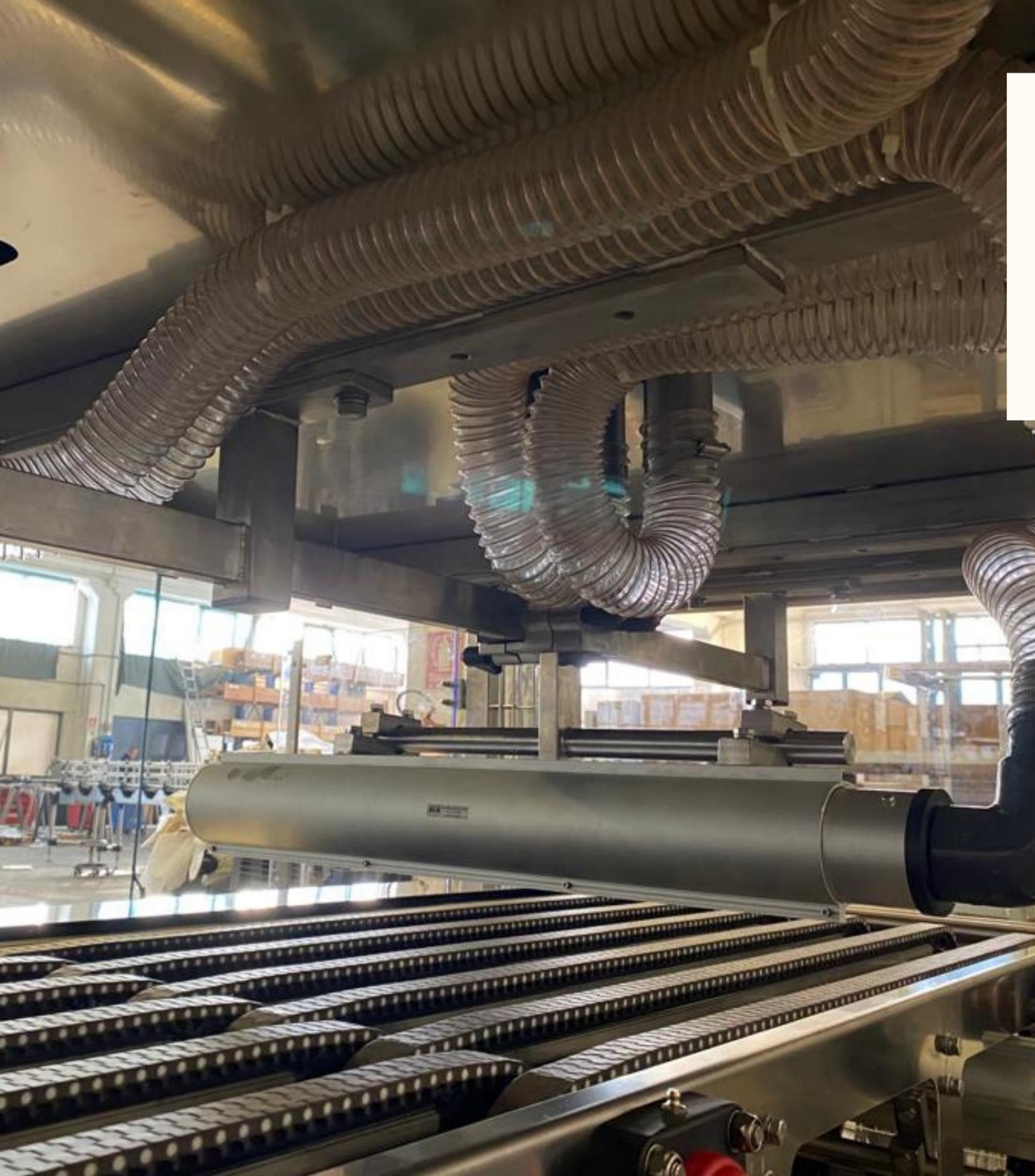
Doppio soffiante da 7.5 kW di tipo centrifugo che alimenta 4 lame d'aria per una potenza di soffiaggio ottimale.
