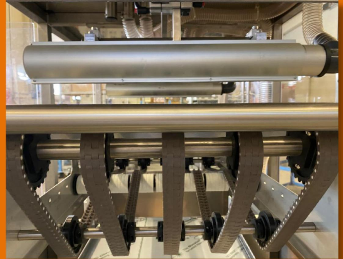
In ingresso e uscita dall'asciugatore sono presenti 2 rulli motorizzati atti a curare al meglio il passaggio delle buste.
